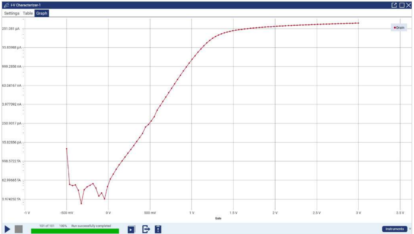
圖 6. KickStart I-V Characterizer App 中以對數刻度顯示的傳輸曲線。
